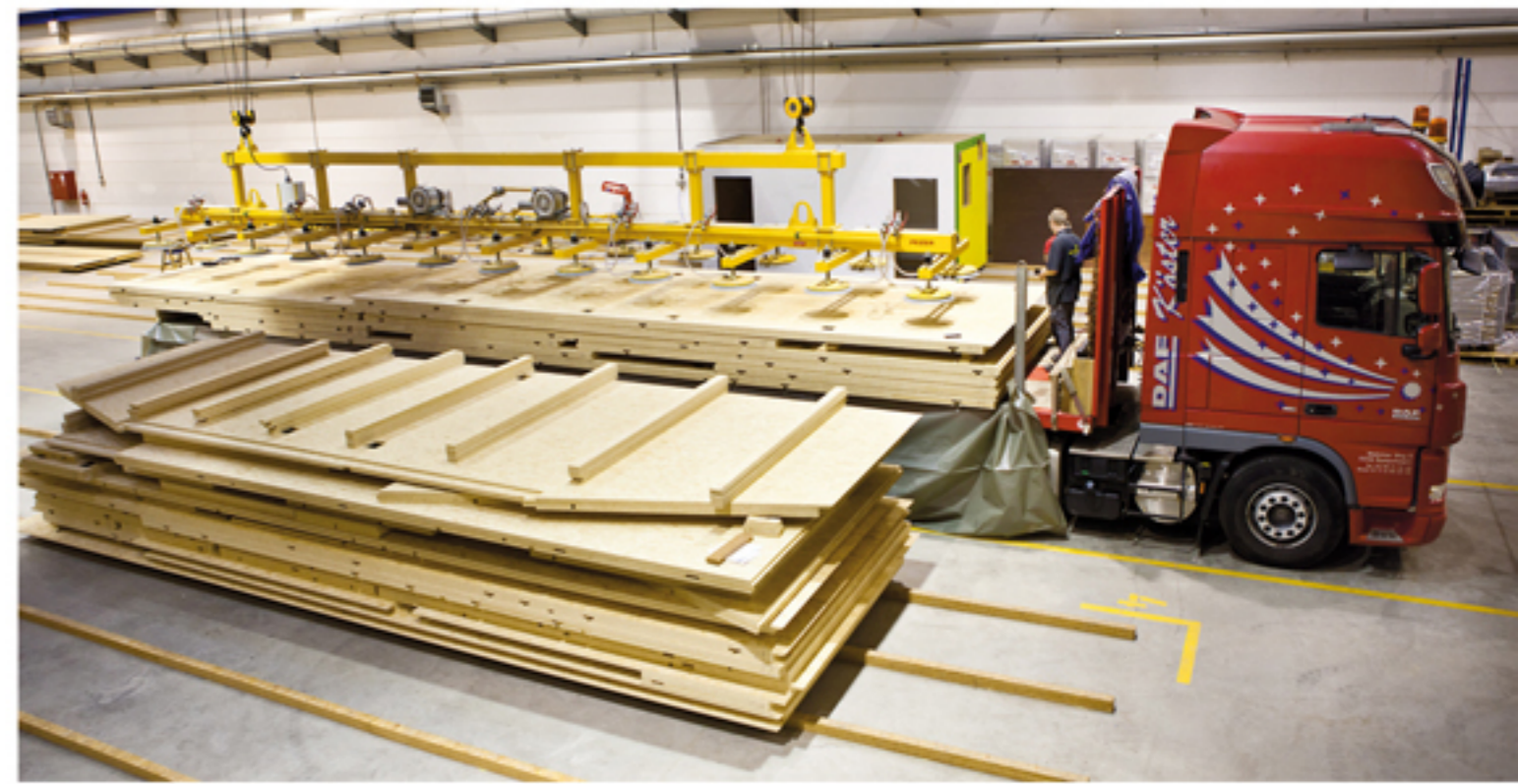
eine durchdachte Stapelreihenfolge ermöglicht die schnelle Montage
