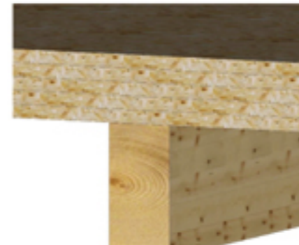
Decke auf Balken
