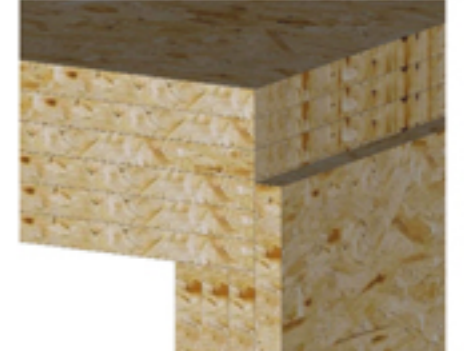
Decke auf Außenwand
